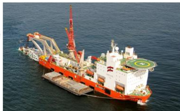
Caesar laying pipe offshore Trinidad GOM
